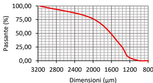
STRUMENTO DI MISURA: MALVERN MASTERSIZER3000E
