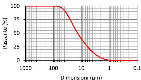
STRUMENTO DI MISURA: MALVERN MASTERSIZER3000E
